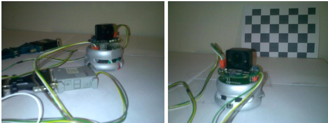
Слика 5: Мобилни робот Khepera II са компатибилном камером KheCMUCam
